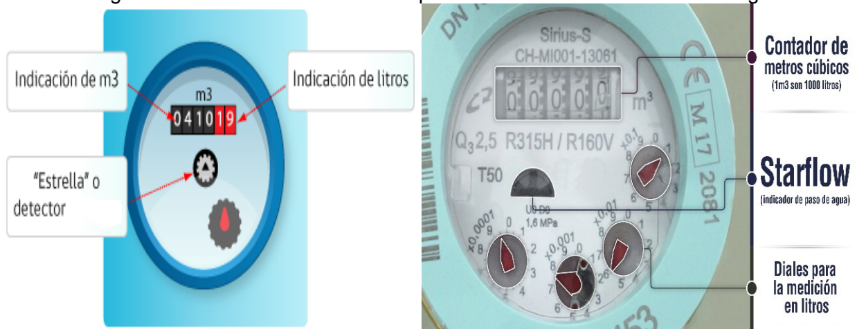
Imagen 1. Toma de datos diferentes tipos de contadores o medidores de agua
