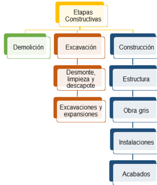
Figura 2. Clasificación de las etapas de construcción
